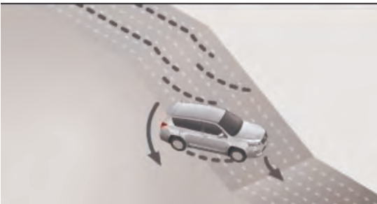
شکل ۲۸- خودروی فاقد سیستم DAC، در سرایشی‌های تند در زمان ترمزگیری چرخ‌ها را قفل می‌کنند.
