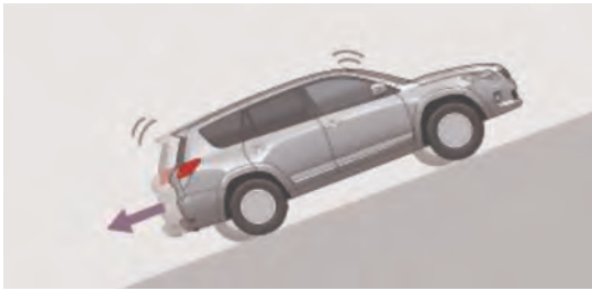
شکل ۲۶- بدون سیستم HAC، حرکت به عقب و یا لغزش در شیب تند رخ می‌دهد.
